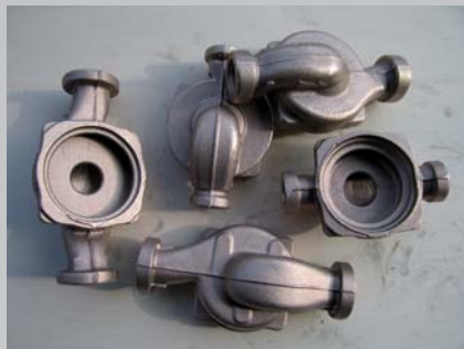
těleso oběhového čerpadla š 90 x v 70 x l 1190 hmotnost 1,20 kg/ks
